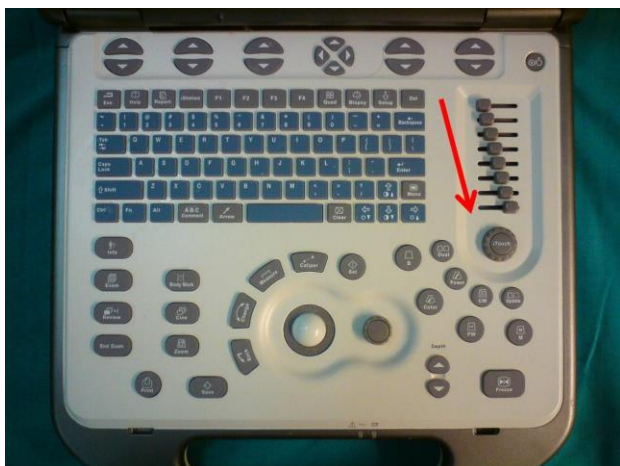
Slika 2. Kontrole ultrazvučnog aparata prikazan je pravilan namještaj TGC.
