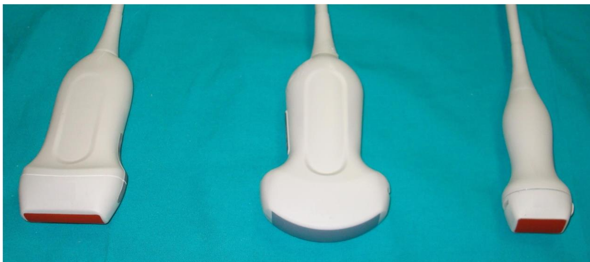
Slika 1. Linearna, konveksna i sektorska sonda.
